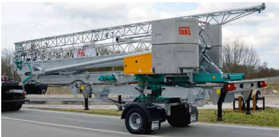
Der hydraulische Untendreher CM 221 ist gerade auf Kurzzeitbaustellen einfach zu handhaben.
