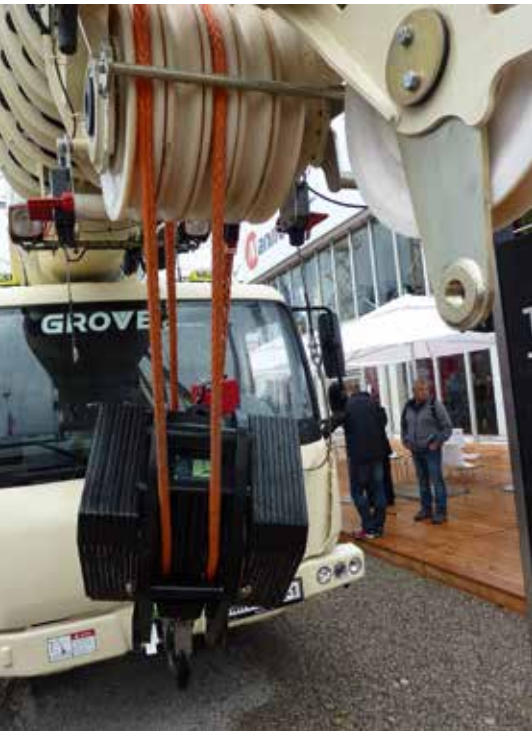
Auch Manitowoc beschäftigt sich mit dem Einsatz von Faserseilen und hat diese für seine Grove-Mobilkrane eingeführt. Bild: ABC
