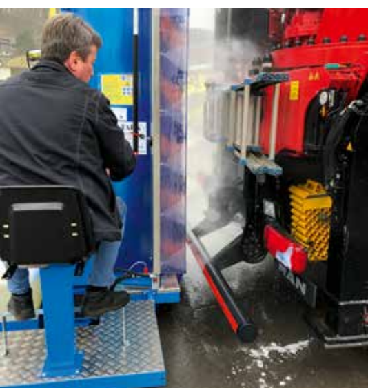
Mit rotierender Bürste und bei Bedarf eingeschalteter Dach-Hochdruckwäsche fährt der Bediener im ersten Arbeitsgang um das gesamte Fahrzeug.
