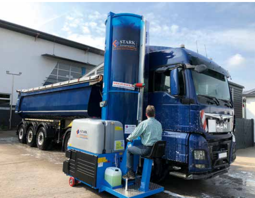
Dank des speziellen Antriebkonzepts sind auch Unebenheiten kein Problem. Der Wassertrank fasst 500 l. Bei zu niedrigem Wasserstand wird automatisch der Motor abgestellt, um Schäden zu vermeiden.
