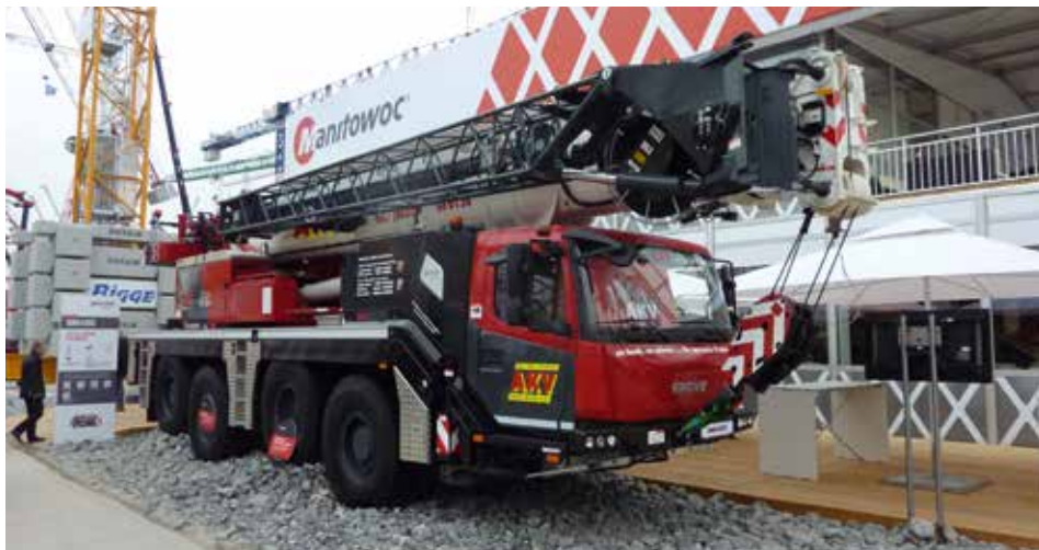
Der GMK4090 bietet noch eine StVZO-kompatible Fahrzeugbreite von 2,55 m, alles was breiter ist als 2,55 m benötigt eine Ausnahmegenehmigung. KM-Bild
