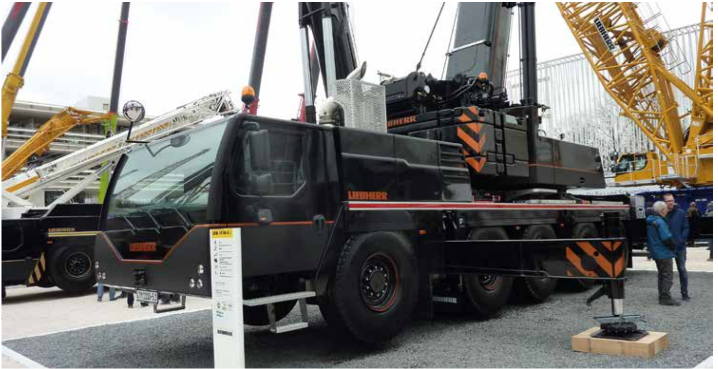
Auch der LTM 1110-5.1, der im letzten Jahr auf der bauma vorgestellt wurde, trägt der zunehmenden Genehmigungsproblematik Rechnung und lässt sich auf 10 t Achslast herunterrüsten. KM-Bild
