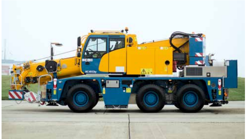
Der AC 45 City lässt sich auf StVZO-kompatible 26 t Herunterrüsten.
