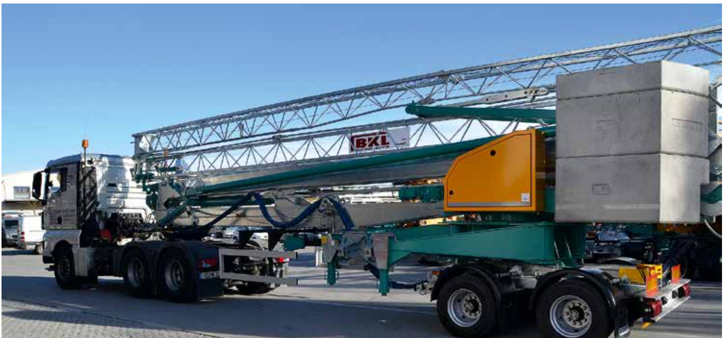
Ein Cattaneo-Untendreher in einer Sattelzug-Baukrankombination.
