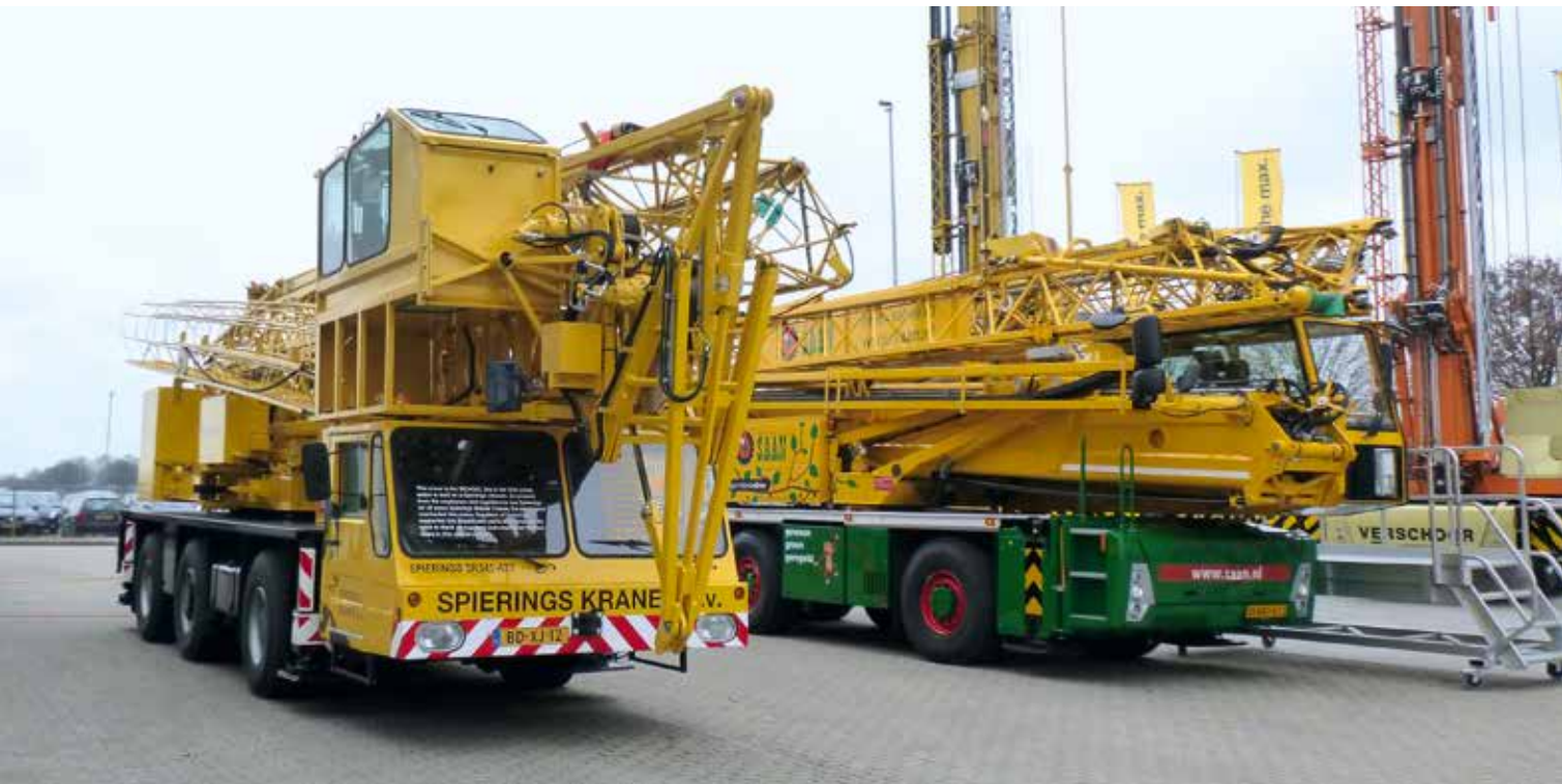
Auch der erste komplette Spieringskran, bei dem der Unterwagen also nicht mehr von MOL stammte, war zu sehen. Der SK345-AT3 stammt aus dem Jahr 1989. Spierings-Mitarbeiter hatten den Kran gemeinsam mit Zulieferern generalüberholt und ihn zum 30-jährigen Firmenjubiläum Leo Spierings als Präsent übergeben. KM-Bild
