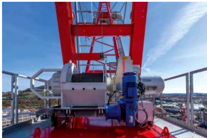
Die 60 kW-Winde Hw 1660 FU kommt sowohl für das Hub- wie für das Einziehwerk zum Einsatz.
