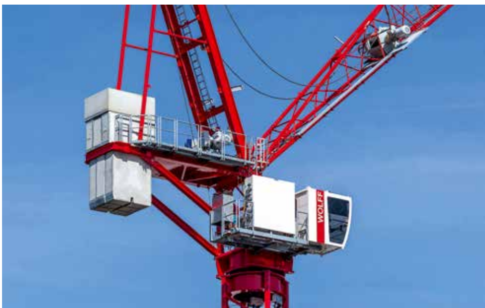
Nur vier Ballaststeine benötigt der neue Wolff-Wipper für den Einsatz.
