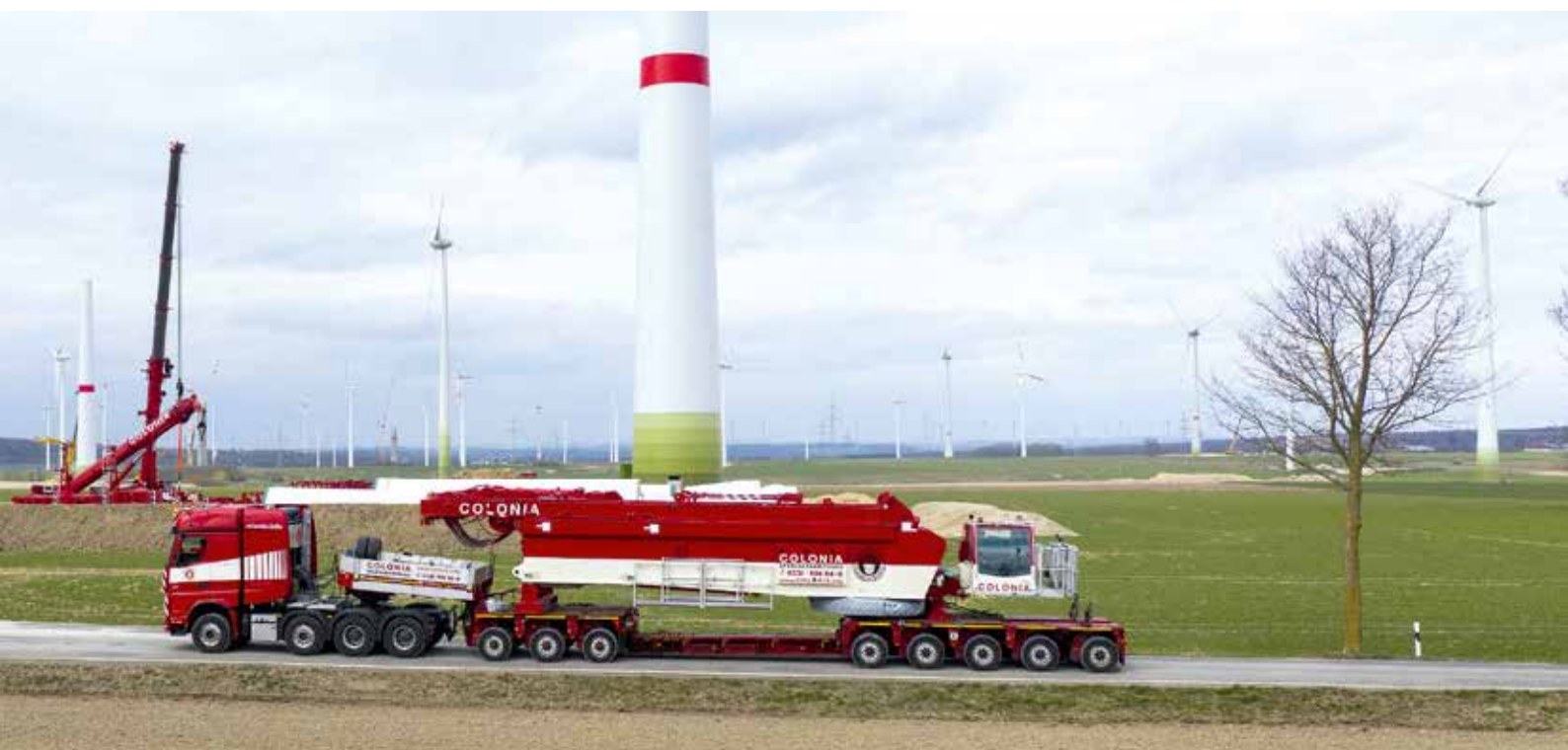
Die Grundmaschine des LR 1800-1-0 ist auf ein Maß von nur 3 m Transportbreite ausgelegt. Hier erfolgt die Anlieferung des Oberwagens.
