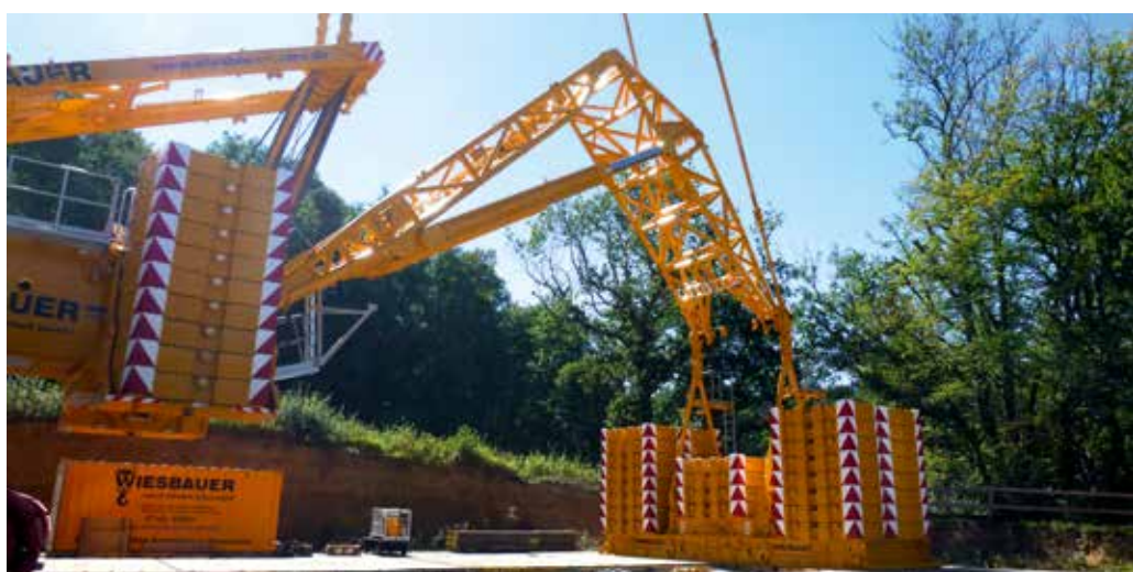
Zwischen 13 und 30 m kann der Radius des Derrickballastes mit dem V-Frame verstellt werden. KM-Bild
