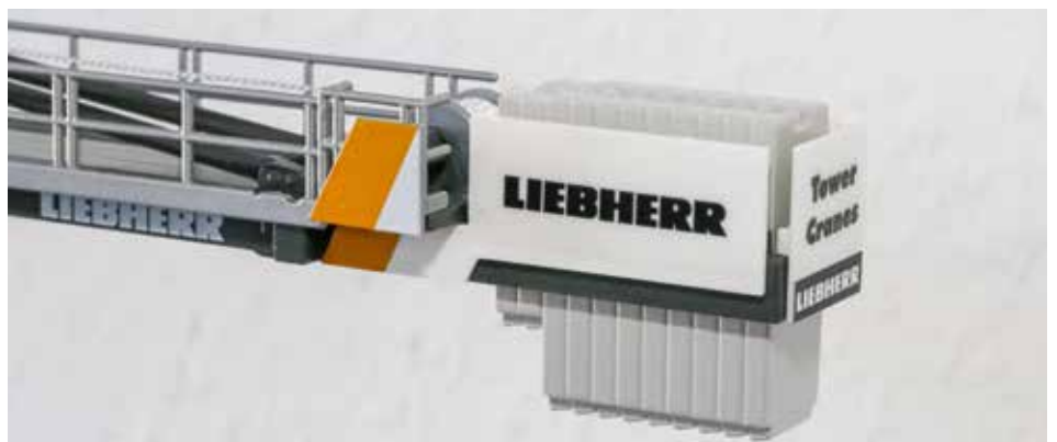
Schön im Detail: der Gegenausleger mit Ballast.
