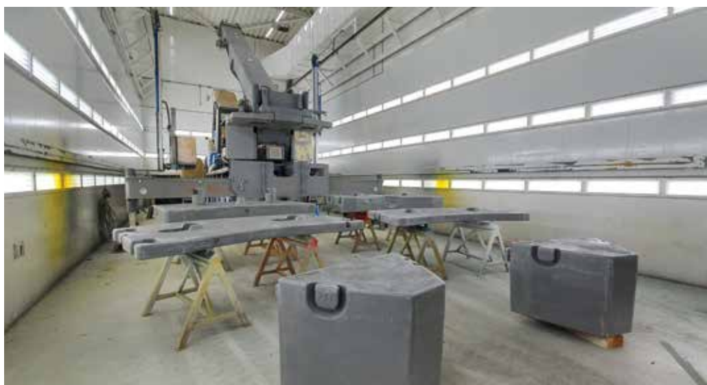
Besonders wichtig und besonders zeitaufwendig die Vorbereitung des zu lackierenden Krans und seiner Teile.
