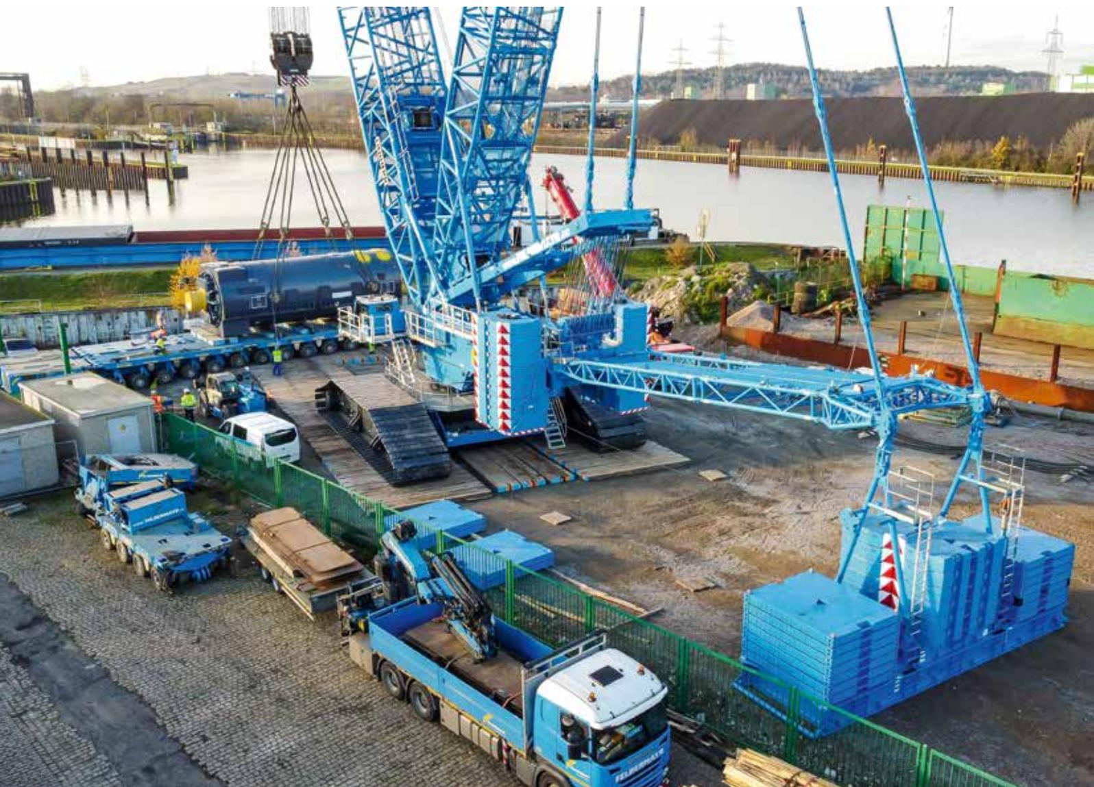
Mit voller Last fuhr der LR 11000 zum Entladen des Generators 20 Meter rückwärts.
