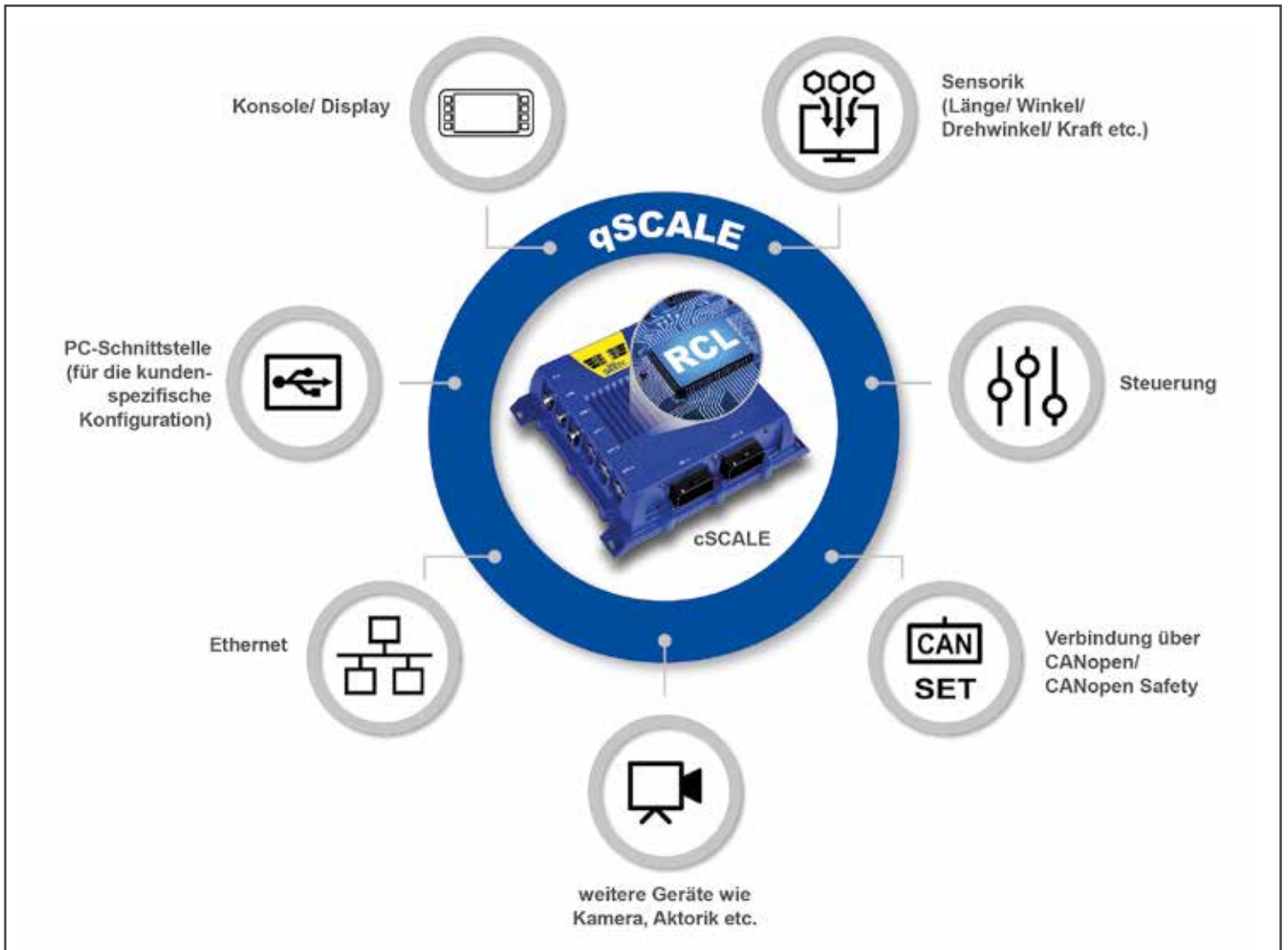
Das qSCALE-System zur Lastmomentbegrenzung.
