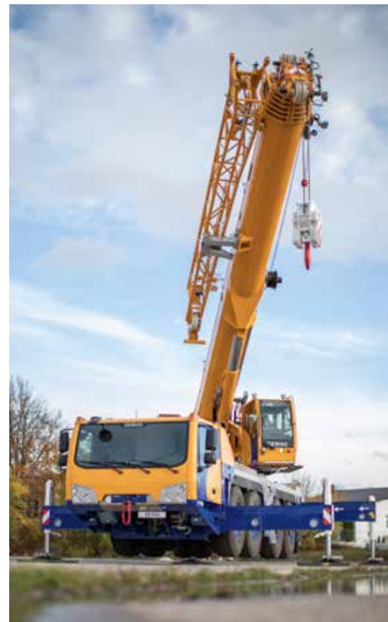
AC 80-4 mit angeklappter Hauptausleger-Verlängerung
