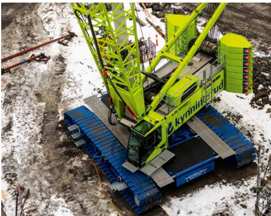
Ende 2020 stellt das Liebherr-Werk Nenzing mit dem LR 1250.1 unplugged den ersten batteriebetriebenen Raupenkran vor.
