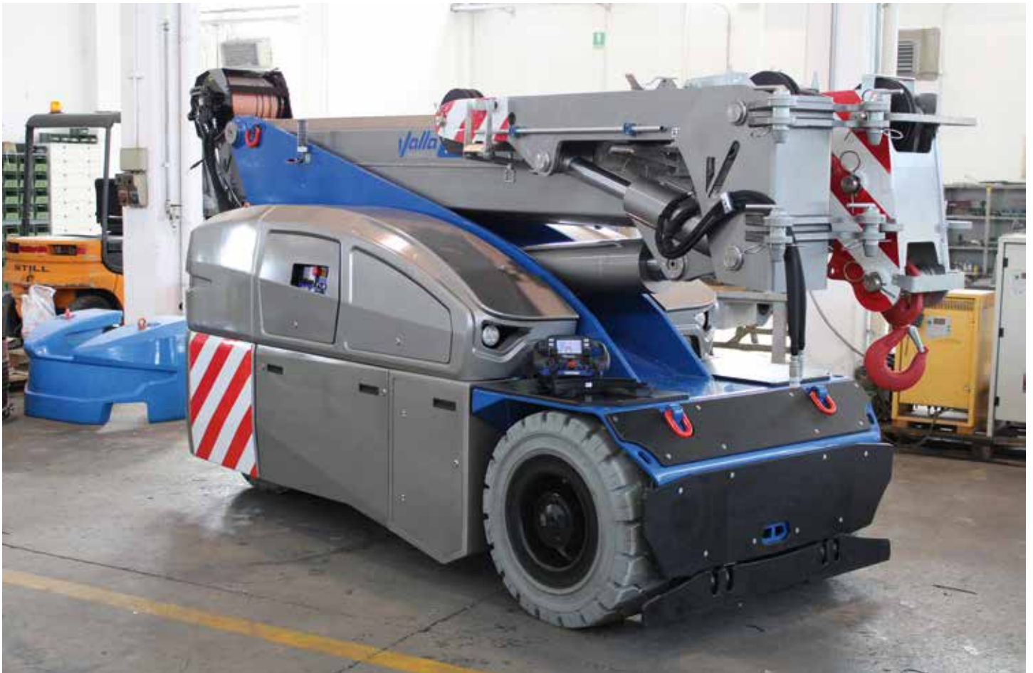
Der V110 R ist mit nichtmarkierender Bereifung ausgestattet und nicht nur dadurch für Einsätze in Produktionshallen bestens geeignet.
