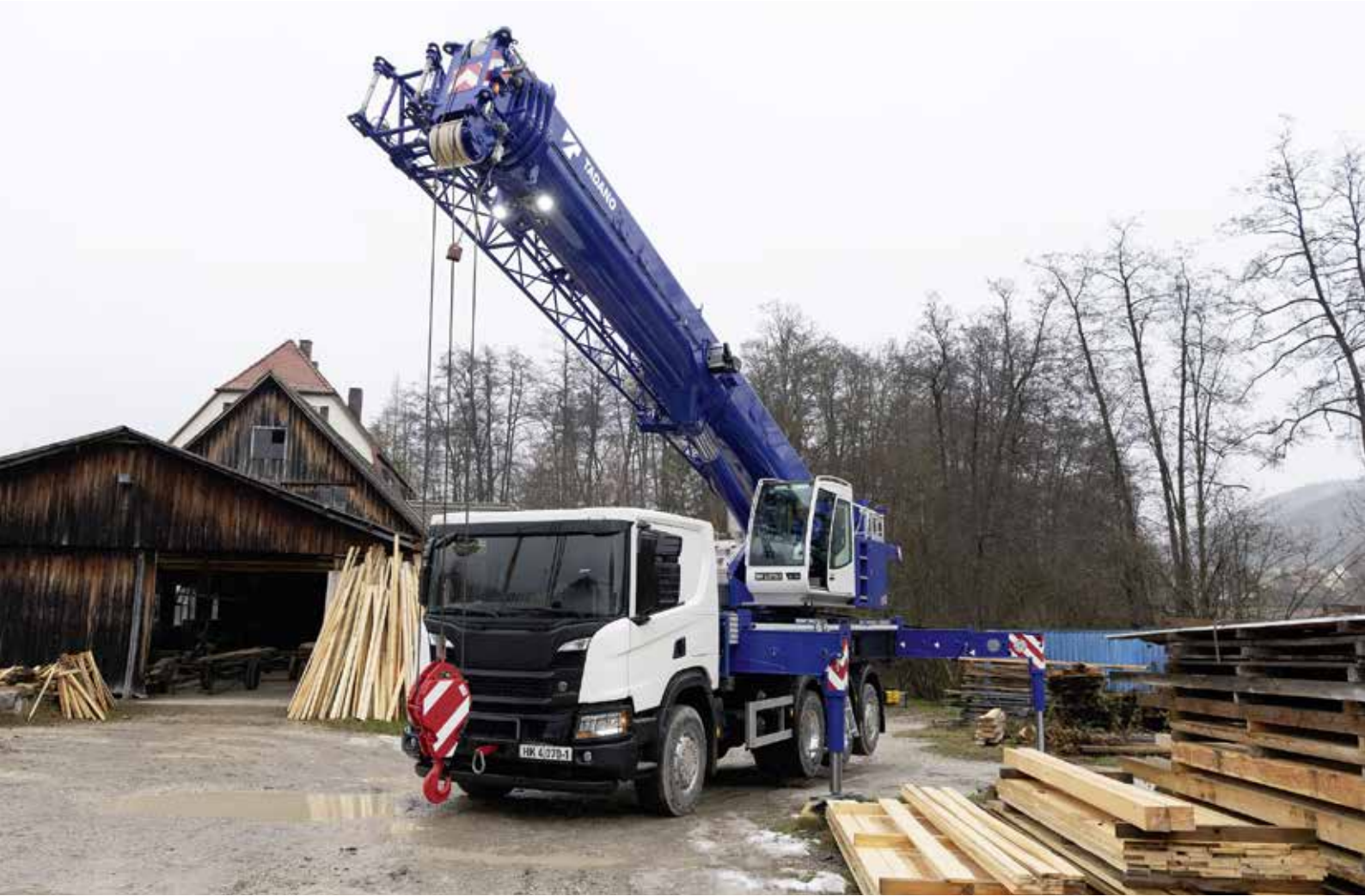
Die H-Abstützung benötigt im Vergleich zur Schwenkabstützung deutlich weniger Platz ...
