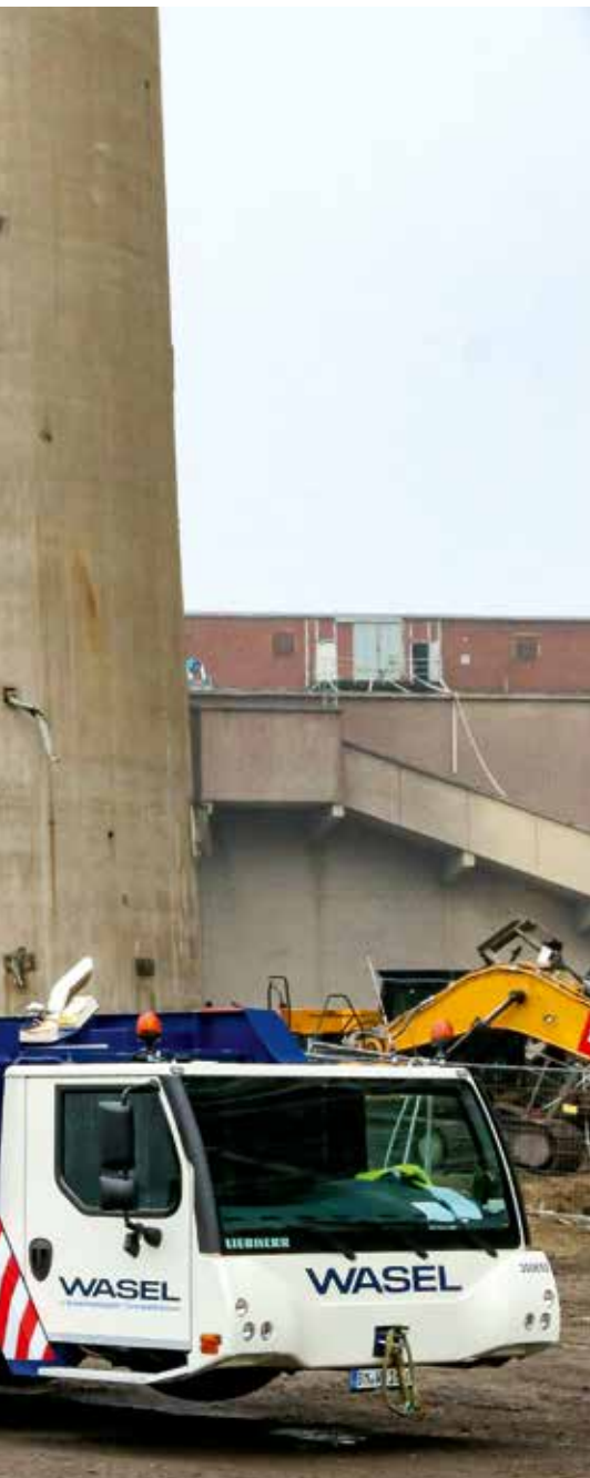
Der LTM 1650-8.1 erreicht mit seinem 54 m Meter Telekopausleger und Anbauauslegern eine maximale Hubhöhe von 151 m, bei einer Ausladung bis zu 112 m.
