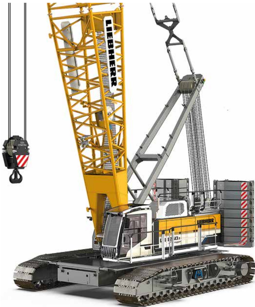
Liebherr LR 1250.1 unplugged – der erste batteriebetriebenen Raupenkran der Welt.
