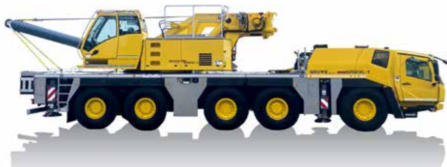
Der abmontierte Hauptausleger des GMK5200-1 und der Verfahrzustand ohne Hauptausleger.
