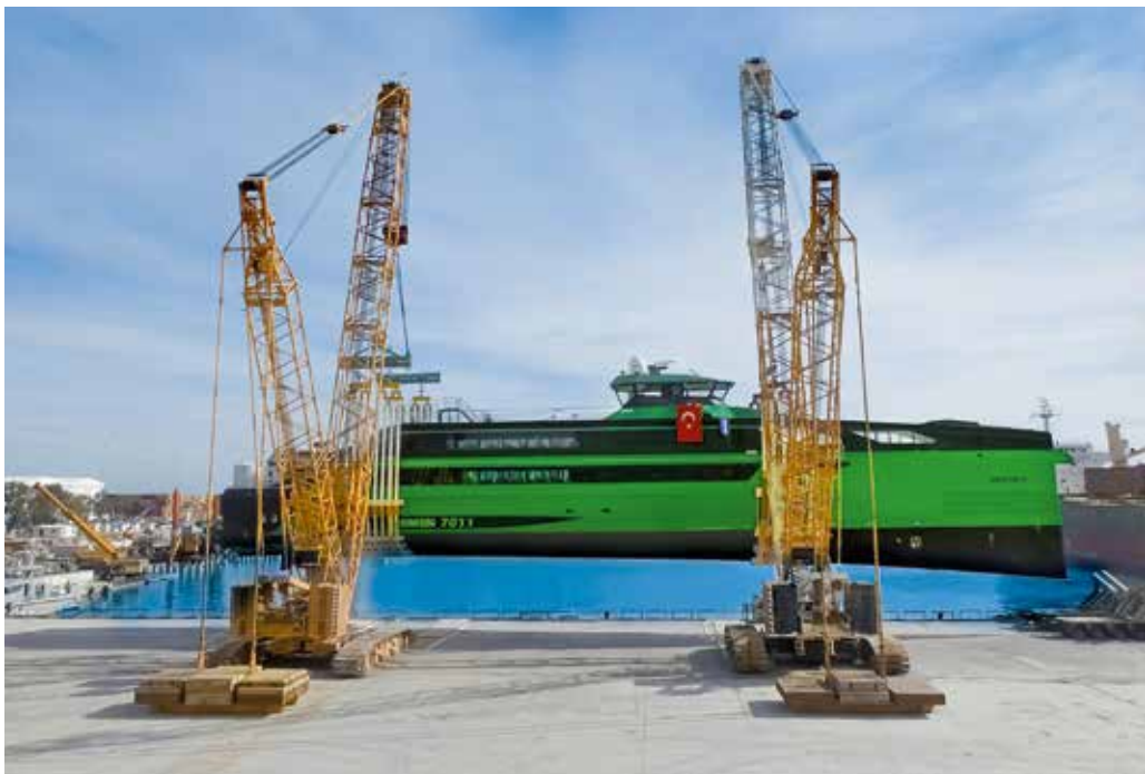
Zwei Demag CC 2800-1-Raupenkrane lassen die Aqua Helix zu Wasser.
