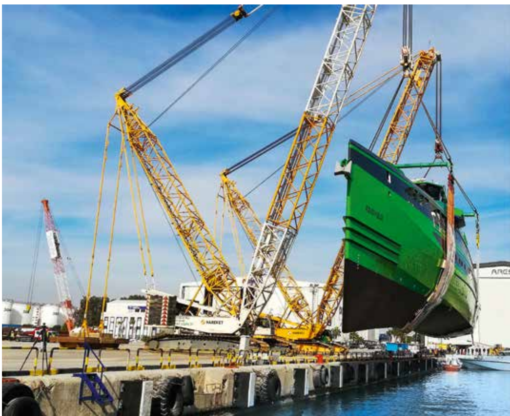
Zwei Demag-Raupen in Superlift-Konfiguration beim Tandemhub.
