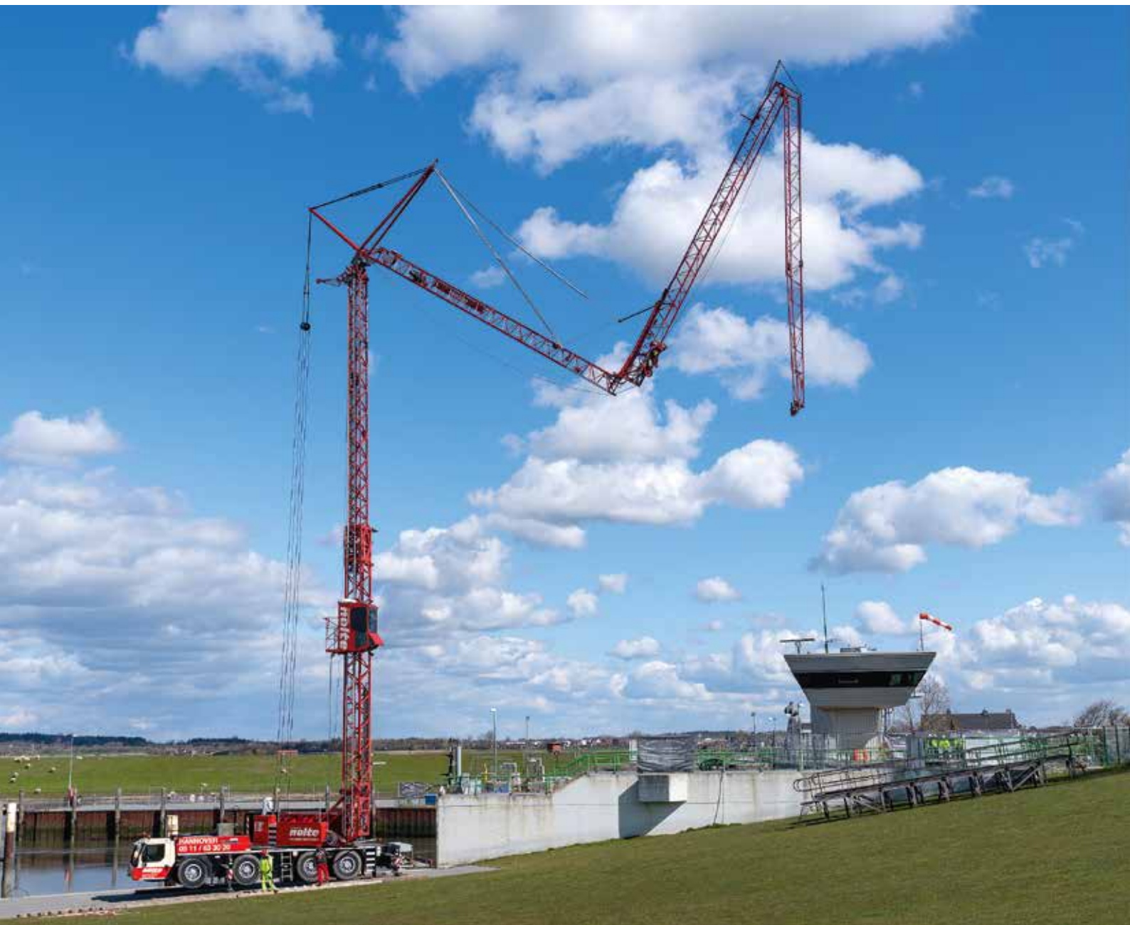
Kran-Origami: Die durchdachte Technik und hohe Konstruktions-Kunst, die im MK 88 Plus steckt, wird schon beim beeindruckenden Entfalten des 45 Meter langen Auslegers deutlich.
