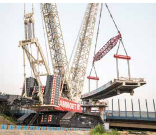
Ein ‚integrierter Stinger‘ am Superlift des 1.600 t-Raupenkran ermöglichte schnelle Lastwechsel.
