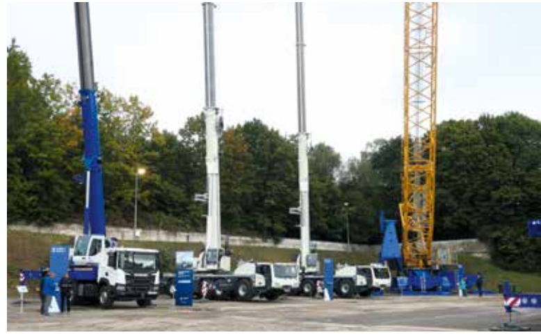
Krane auf dem Demo-Gelände (Mobilkrane mit 4 und 5 Achsen, Raupe).
