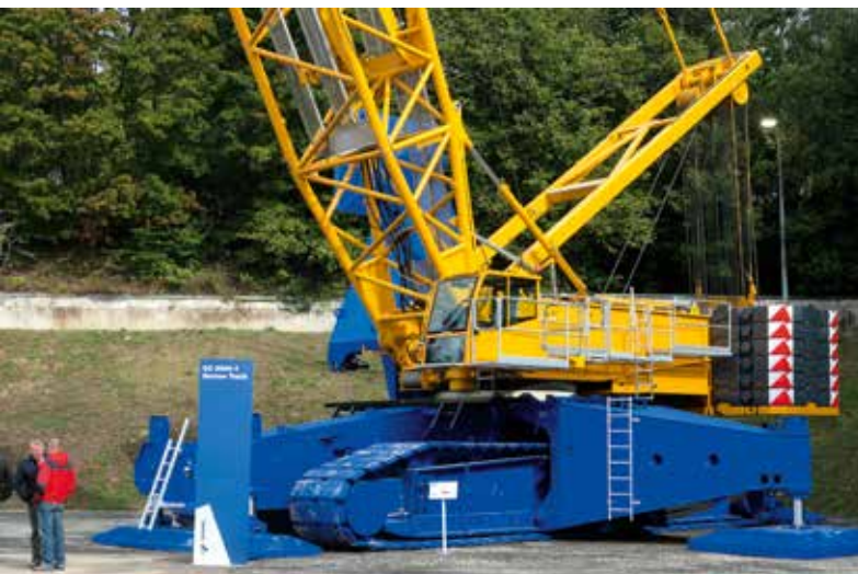
Der Raupenkran CC2800-1 mit enger Spurweite.
