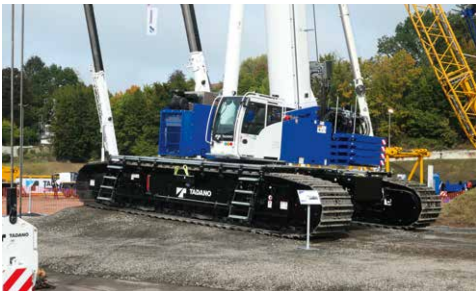
Raupenkran GTC-1800EX in 4° Schräglage.
