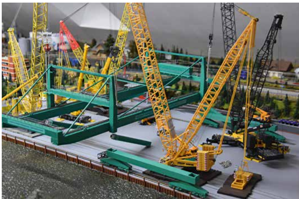
Hub einer 1.232 Gramm schweren Containerbrücke auf die Fahrwerke. Eingesetzte Krane: 2 x LR 1600, 1 x CC 6800-1, 1 x AK 850, 1 x LTM 1250, 1 x LTM 1045, sowie drei Steigerwagen.
