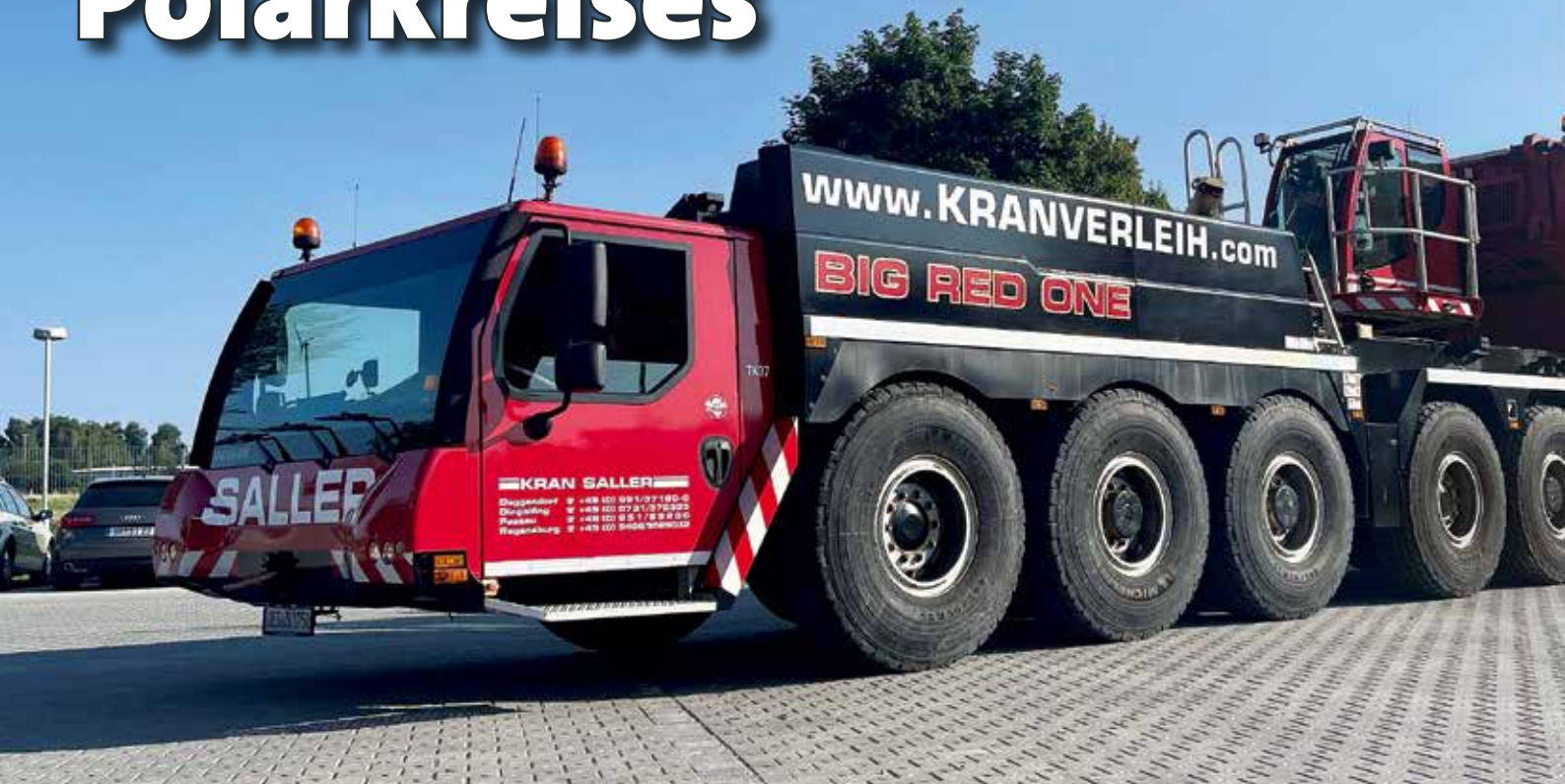
LTM 1750-9.1 mit demontiertem Hauptausleger.
