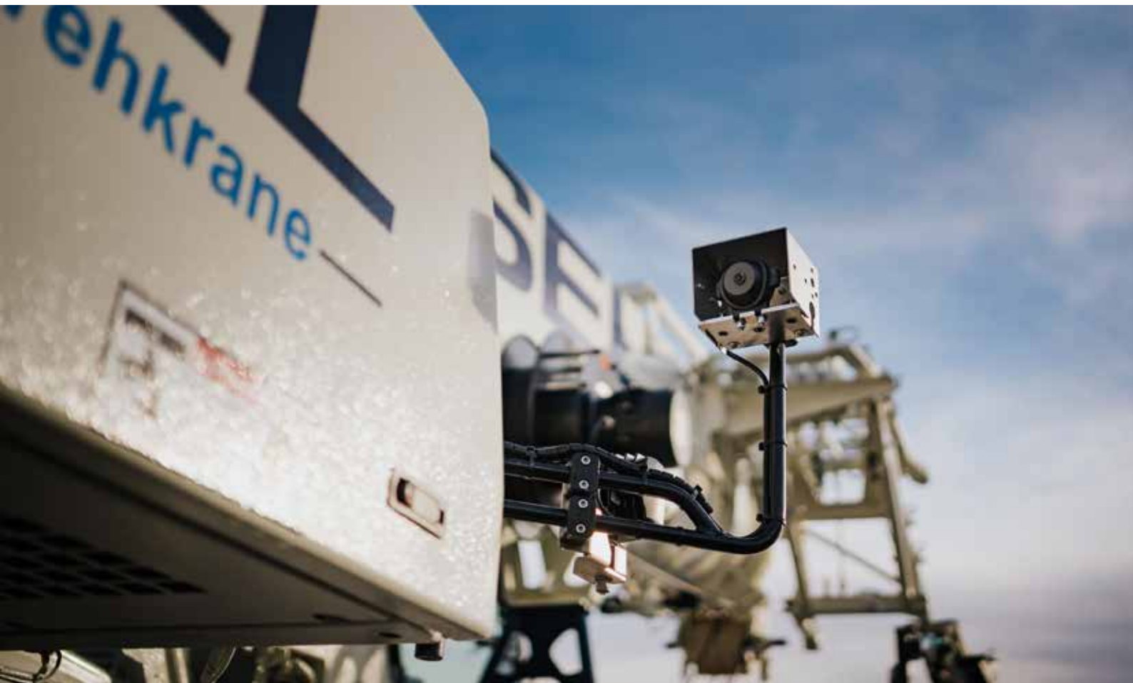
Ebenfalls neu: die Seitenkamera zur Beobachtung der rechten Fahrzeugseite.
