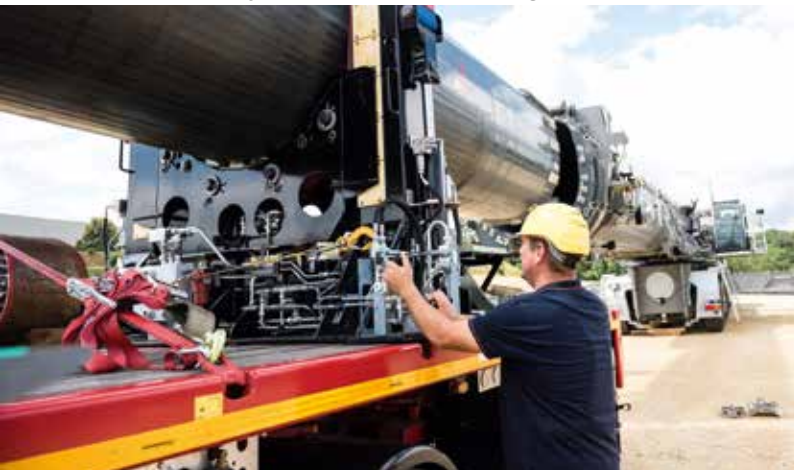
Die hintere, hydraulisch gesteuerte Ladeeinrichtung.
