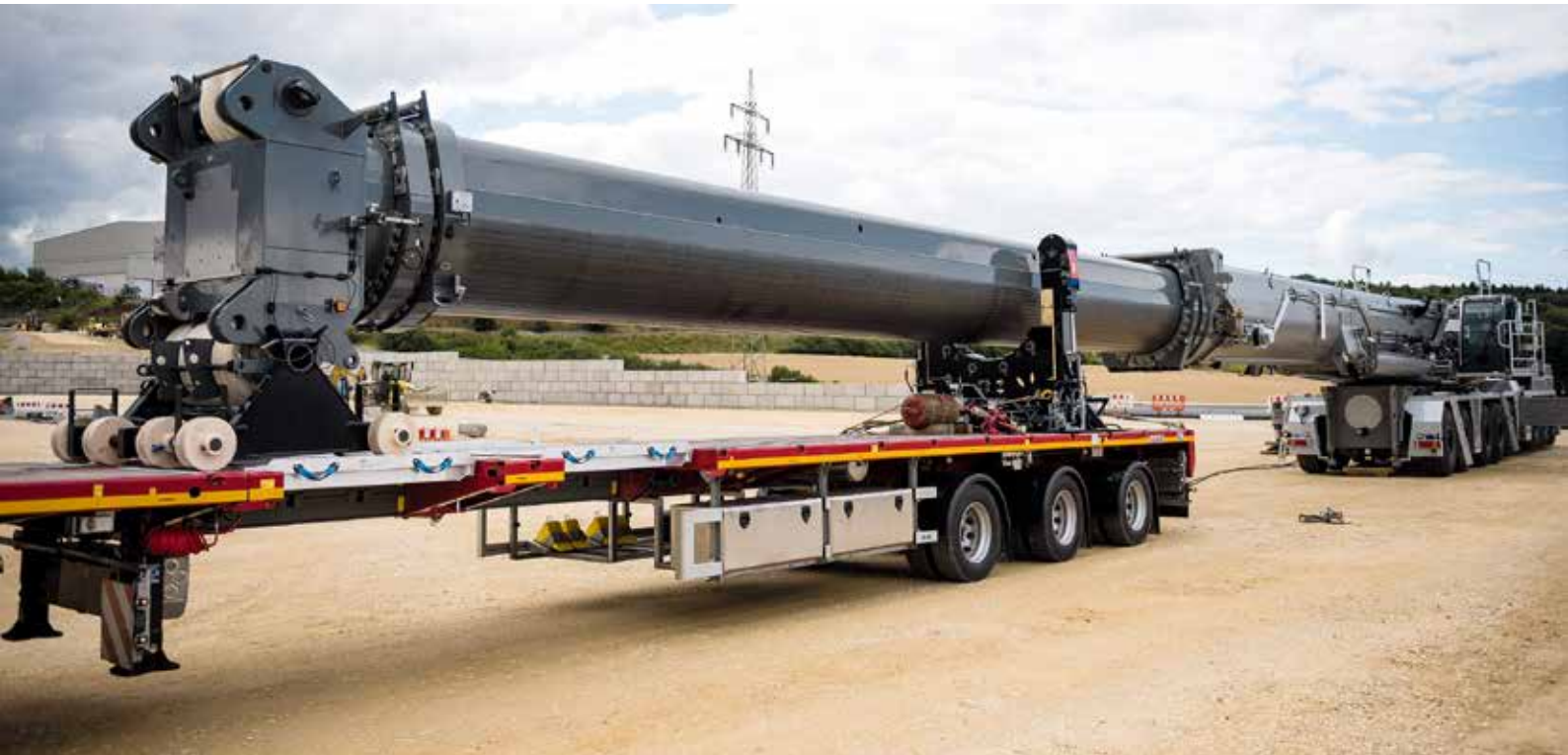
Links im Bild: die vordere Ladeeinrichtung mit Rollen.
