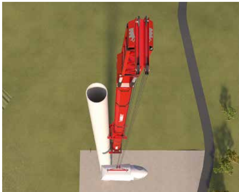
Die WTA installiert Turmabschnitte, Schaufeln und Gondeln und nutzt den Turm selbst zur Unterstützung. Eine Reihe von Klemmen verbindet die WTA mit dem Turbinenturm, so dass sie jede Hubposition erreichen kann.
