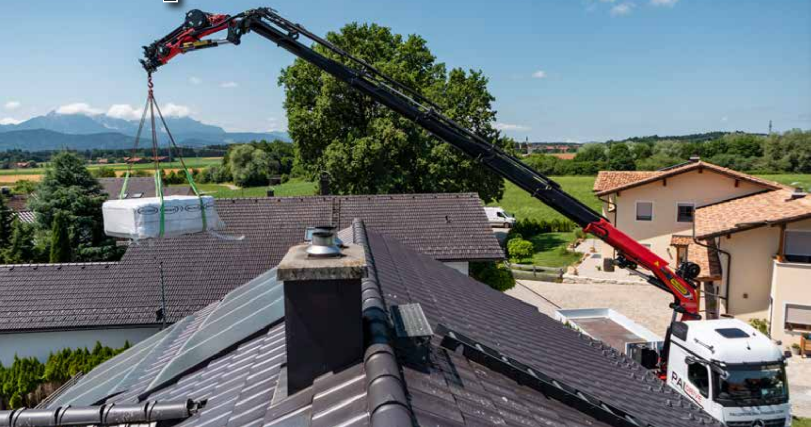
Der PK 58.002 TEC 7 hebt den 400 kg Jacuzzi über das Garagendach.
