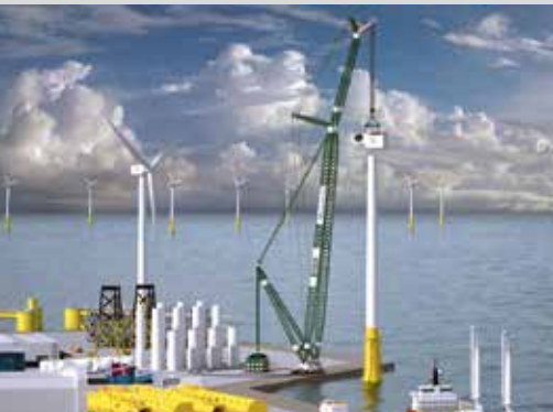
So soll der neue Huisman Ringer Crane mit einer Kapazität von 3.000 Tonnen in BMS-Farben aussehen.
