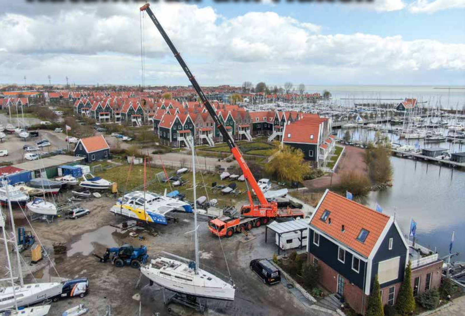
Tadano ATF 130G-5 der niederländischen Mick Volendam Gruppe hebt 9-Tonnen-Schiff aus dem Ijsselmeer.
