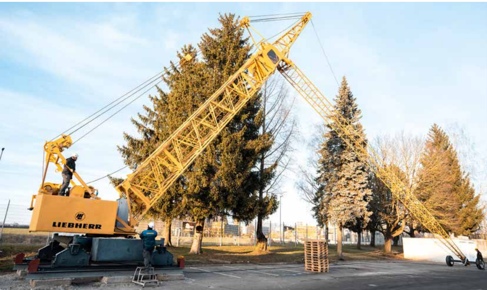
Der Liebherr Form 30A/35 wird vor dem Liebherr Tower Crane Center in Bad Waldsee aufgerichtet.
