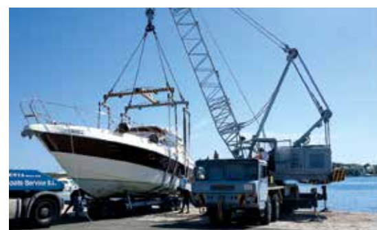
Der Demag TC 150 hebt max. 50 t und oft hängt ein Boot mit mehr als 20 t am Haken.
