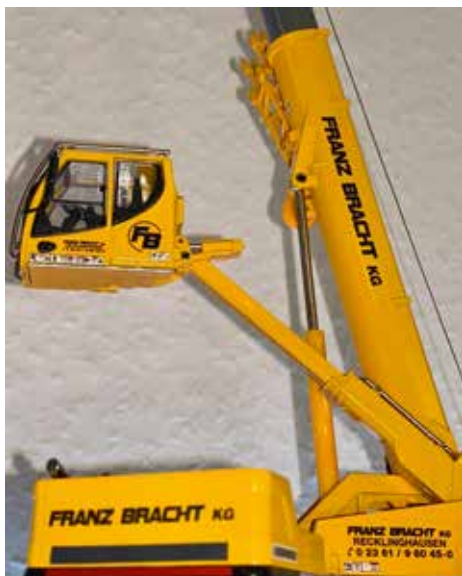
...vollständig austeleskopiert und mit hochfahrener Krankabine.
