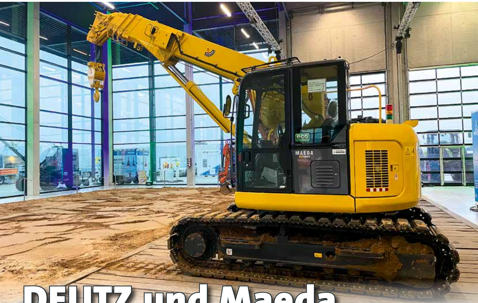
Mini-Kran mit Hybrid-Antrieb.
