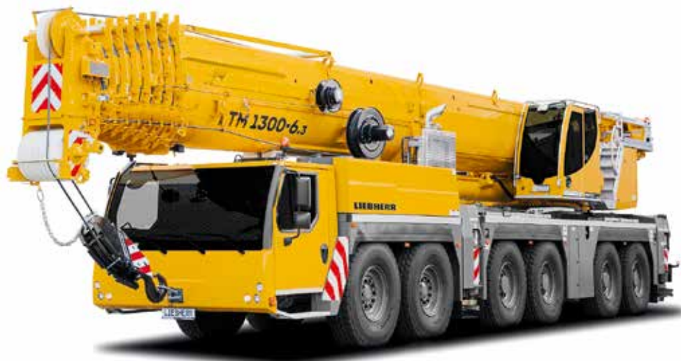
Das Highlight des LTM 1300-6.3: Der 90 Meter lange Teleskopausleger.
