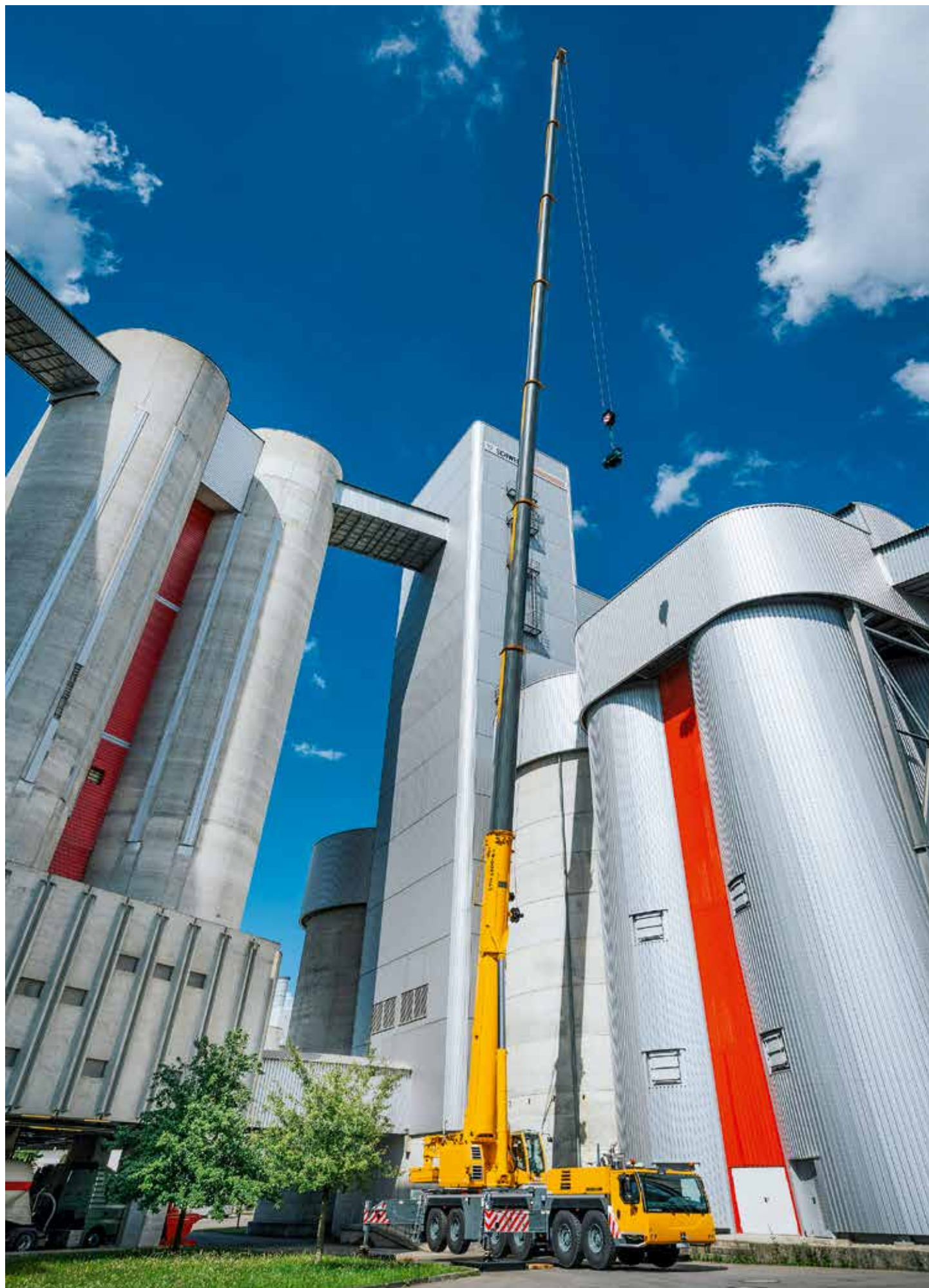
Der LTM 1300-6.3 konzipiert für großen Hubhöhen und steile Auslegerstellung.
