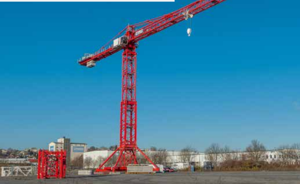
Die ersten drei Auslegerteile sind als 4-Gurt- statt als 3-Gurt-Variante konstruiert.
