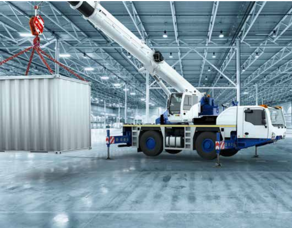
Tadano AC 2.040-1 beim Halleneinsatz.
