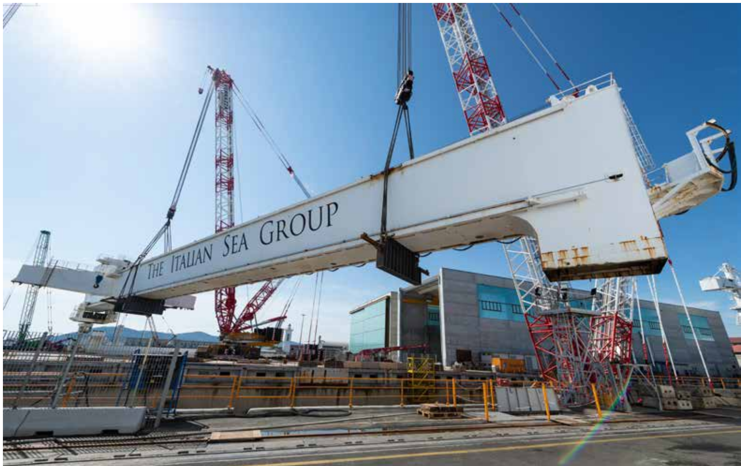
Speziell angefertigte Anschlagmittel: Einzeltraverse am CC 3800-1 Doppeltraverse am CC 6800.
