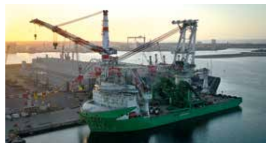
Offshore-Schiff „Orion“ mit dem montierten Liebherr-Kran HLC 295000.
