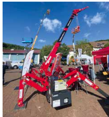
Minikran UNIC-B-350.2V mit variabler Abstützung und hydraulischer Spitze.
