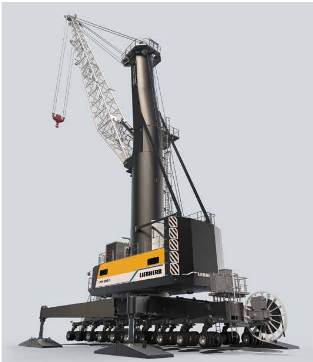
Der neue Liebherr Hafemobilkran LHM.
