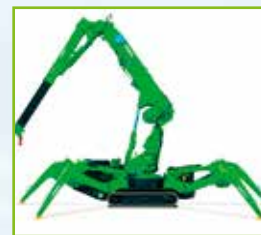
Das erweiterte Abstützdesign bietet 15 verschiedene Positionen pro Stütze.
