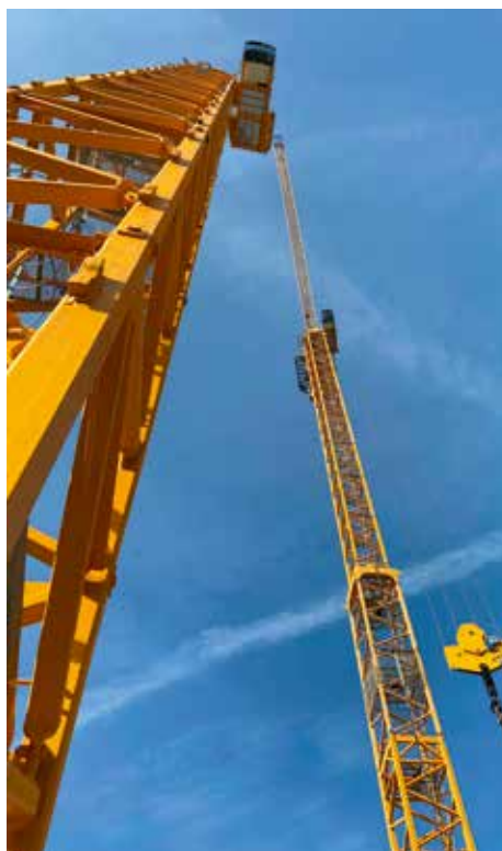
Die Wippausleger der Potain-Krane können zu fast 100 % senkrecht aufgerichtet werden.
