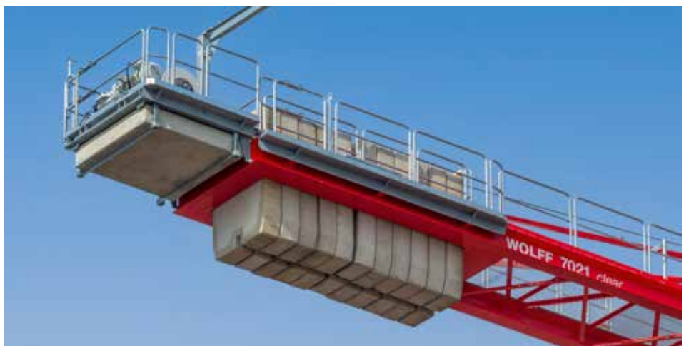
Der neudesignte Ballastrahmen für die Hubwinde lässt sich leicht montieren und für den Transport dank Schnellverbindung sehr einfach entfernen.
