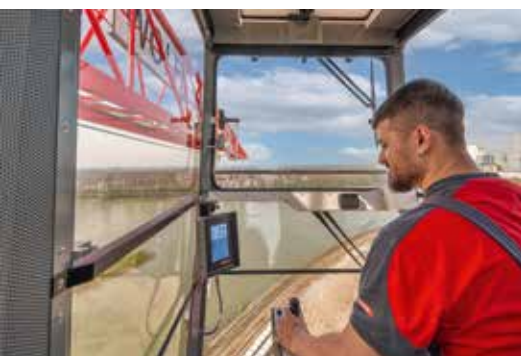
Ein neues Podest zwischen Ausleger und Kabine ermöglichen dem Kranfahrer einen Akkumtausch des HiSPS ohne Sicherheitsausrüstung.
