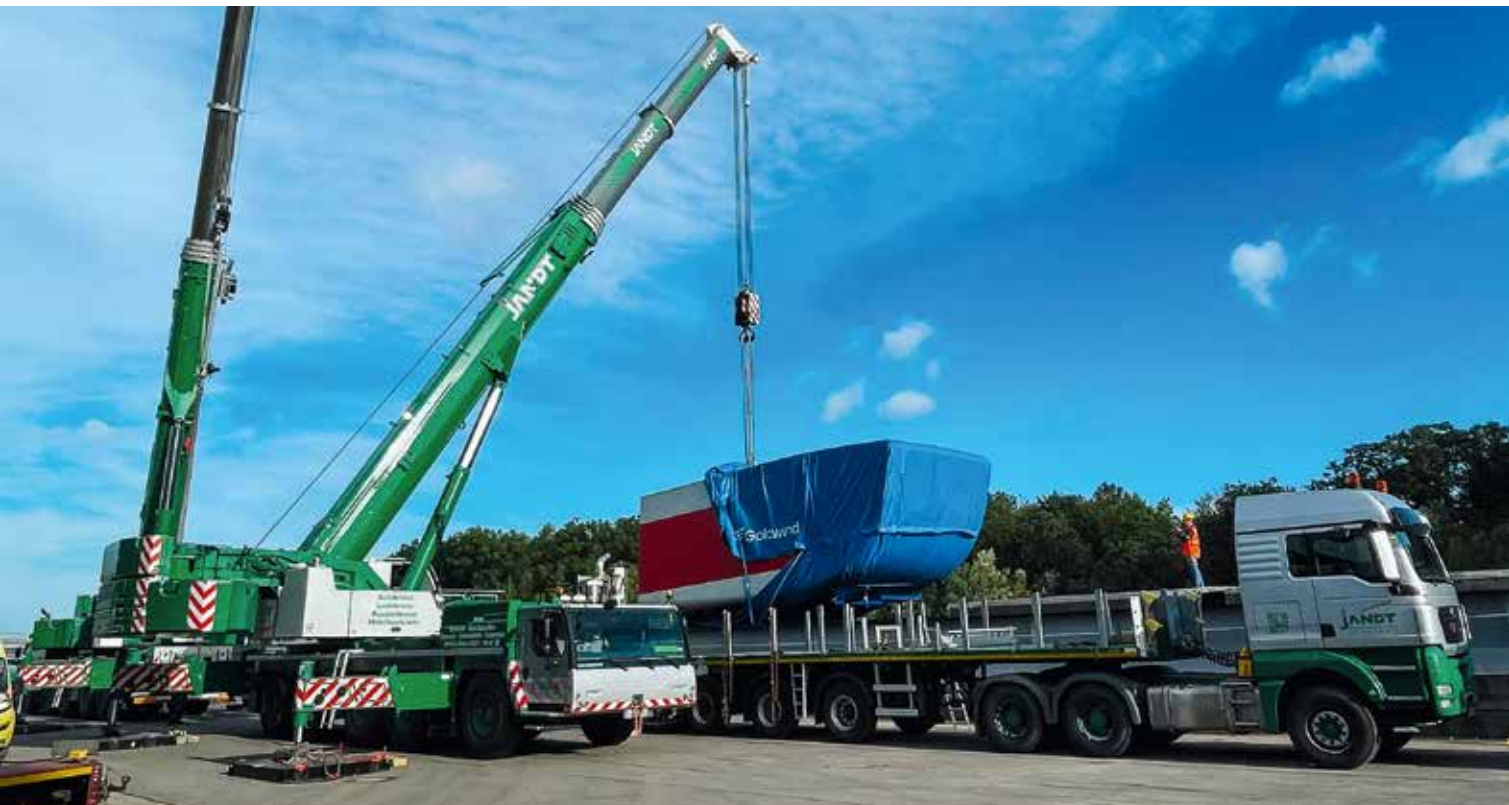
Für das Verladen des leichteren Maschinenhauses reicht ein LTM 1250-5.1 aus.
