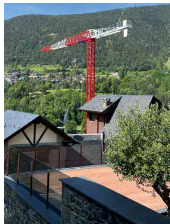
STF 5030 Flat-Top, mit 8 Tonnen Maximal- und 3 Tonnen Spitzenlast ausgeliefert an EuroCrane in Andorra.
