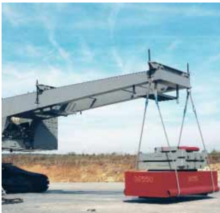
LR 1750 mit Aufrichterahmen und circa 60 t Schwebeballast.
