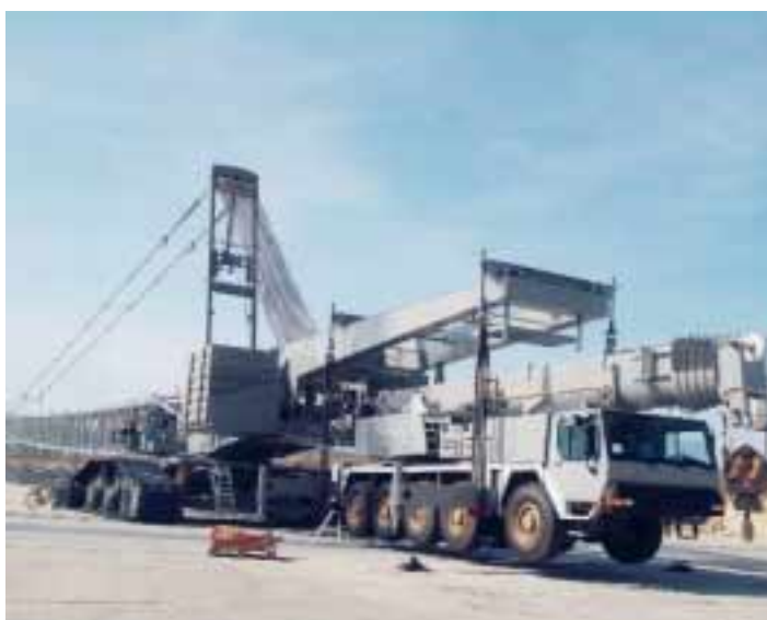
Ein LTM 1100/2 (circa 60 t) wird an den Aufrichterahmen angehängt und dient dem Raupenkran LR 1750 so als „Ersatzballast“.
