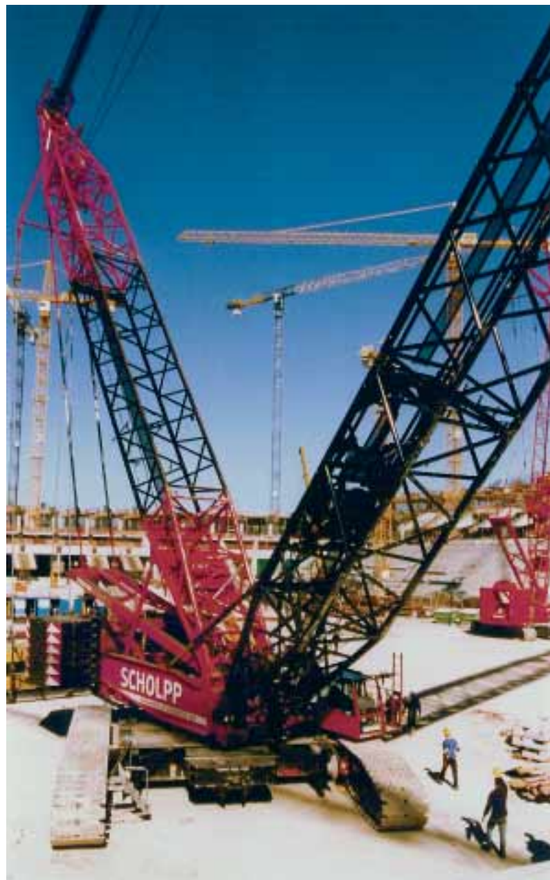
Mit den IHI-Kranen umfasst das Terex-Demag-Raupenkranprogramm jetzt Geräte von 50 bis 1.600 t Tragkraft. Im Bild: CC 2500, Betreiber Scholpp, Einsatzort München Allianz Arena. KM-Bild
