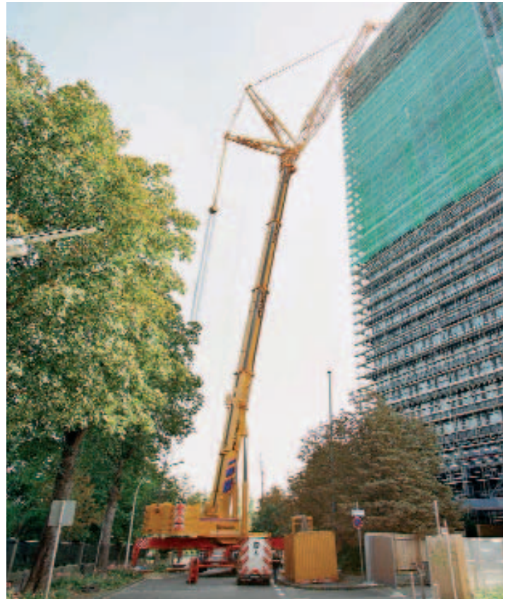
Die Wippspitze des AC 650 lässt sich zur Überwindung von Störkanten abwinkeln.
